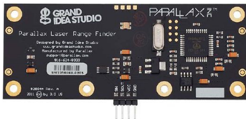
Figura 3.44 Partea posterioară a modulul de măsurare a distanței: circuitul de procesare date
